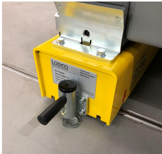
Bild: Speziell adaptierte Rollplattformen mit Aufnahmewinkeln und einer Arretiervorrichtung zum Fixieren der Baugruppen an den Montagestationen
