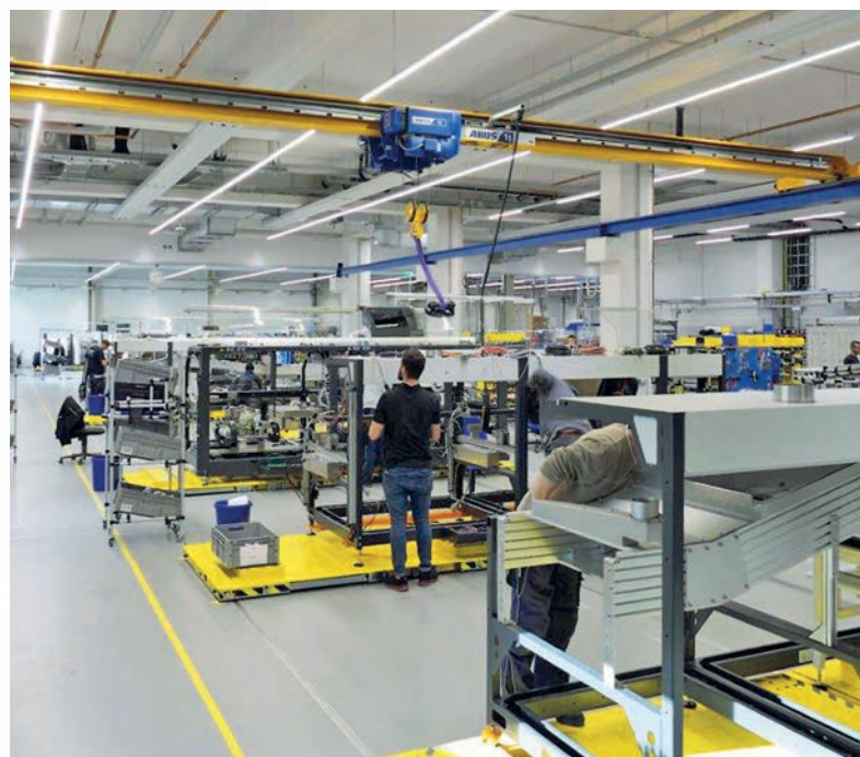
01 Rundschiensystembasierte Fließfertigung ist für die Herstellung unterschiedlich dimensionierter Lötanlagen ausgelegt
