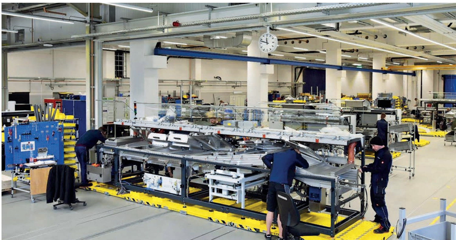
02 Hier ist das LOXrail-System mit drei gekoppelten Transportwagen für die Fertigung von großen Lötmaschinen zu sehen
